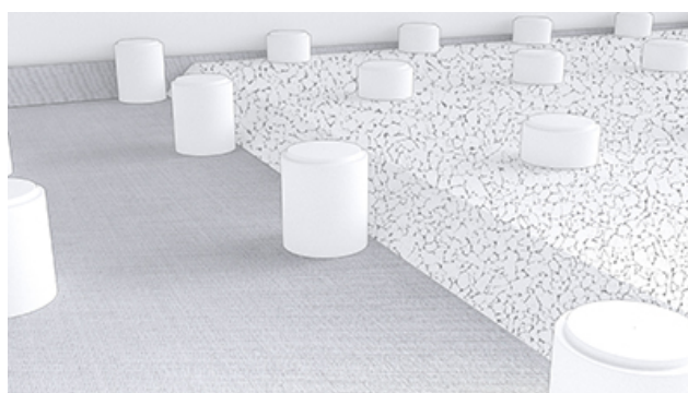
6. Wypełnij wykop mieszanką żwiro-piasku.
